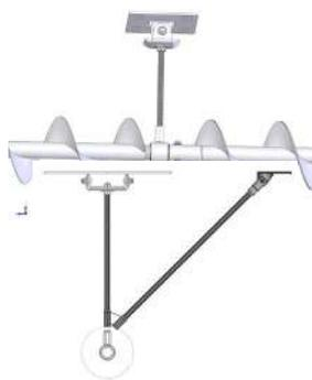
Lorsque le silo est en sous-sol du bâtiment et qu'une trémie de bennage peut être aménagée sur la façade, la vis de remplissage horizontale est une solution simple et efficace. L'angle de la vis ne doit pas dépasser 30°.
